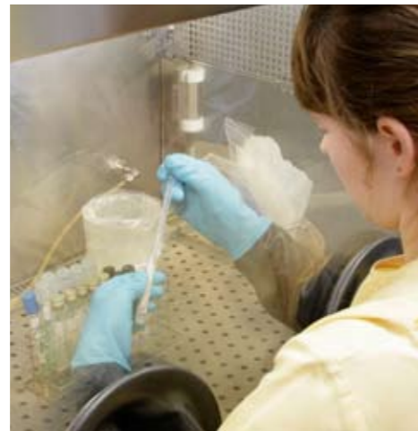
2 De monsters worden uitpakkt in de met filters en glas beveiligde biohazard-kast. Laboranten kunnen op deze manier veilig werken met hoge concentraties en multiresistente levende bacillen. De kast staat in het BSL3-laboratorium (Bio Safety Level 3). Hier worden mycobacteriën onderzocht die mogelijk ernstig ziekteverwekkend zijn, zoals tbc. Het lab heeft een constante onderdruk, zodat geen lucht (en bacillen) naar buiten kan. 's Nachts gaat automatisch het ontsmettende UV-licht aan.
