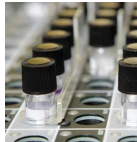
4 Rijen tbc-monsters in de 'vloeibare kweek'. In deze kast worden de klassieke verwekkers van tbc bij een constante temperatuur van 36 graden Celsius volledig geautomatiseerd getest op hun resistentie tegen verschillende soorten antibiotica. Zodra een kweek positief is, geeft de indicator in het buisje een lichtsignaal.
