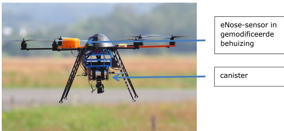
Figuur 9: oktokopter met geïntegreerde eNose en canister
