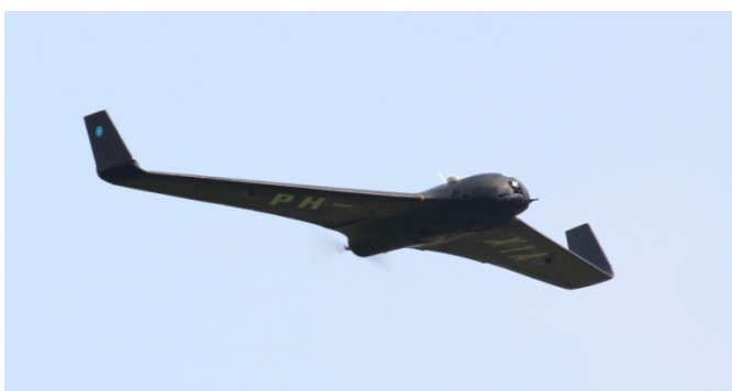
Figuur 10: Skywalker X8-aeroplane met geïntegreerde eNose en canister
