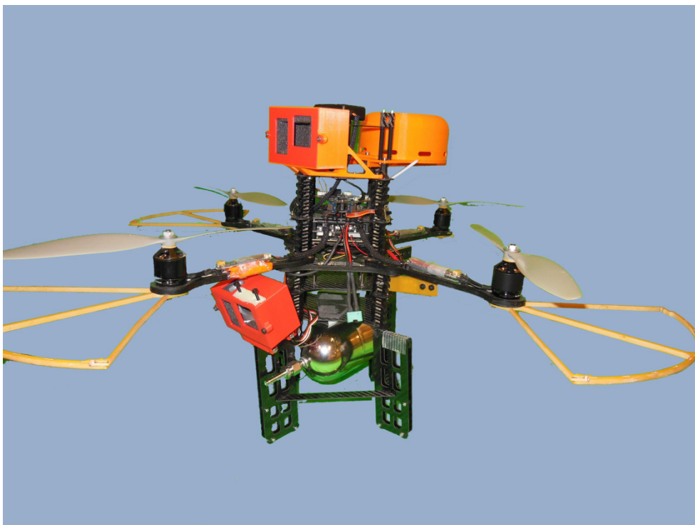
Figuur 36: foto van een Pelikan-quadrokopter met een eNose (in oranje behuizing, bovenaan, achterzijde), een canister (metalen voorwerp onderaan) en twee behuizingen voor camera's (oranje behuizing, bovenaan, voorzijde en links onderaan).
