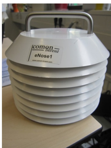
Figuur 2: eNose-behuizing en meetvoorbeeld
