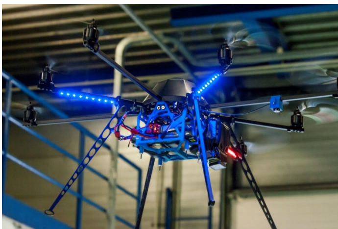
Figuur 20: dosistempomonitor en GoPro aan Oktokopter
