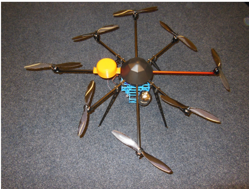
Figuur 37: foto van een Mikrokopter-okto met een eNose (oranje behuizing) en een canister
