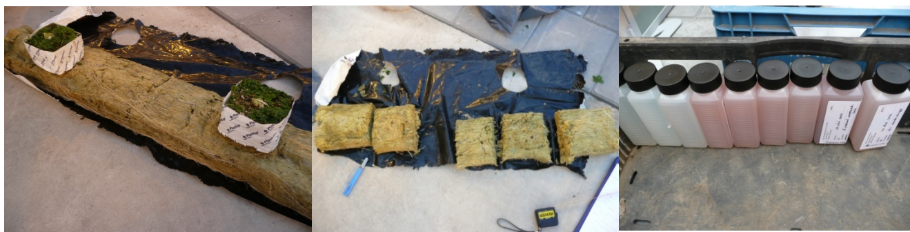
Figure C - 5 links: draingat zit links. Folie gescheiden in onder en boven (met plantgaten); midden: in blokken gesneden; rechts: monsterflesjes GAC
