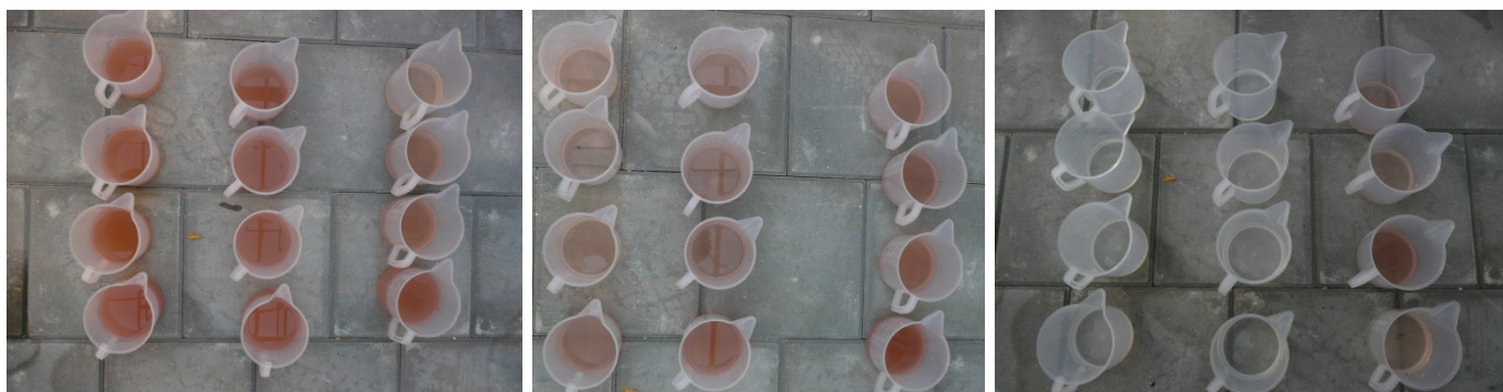
Figure C - 3 overzicht gietbeurten 1 (links), 2 (midden), 3 rechts). 1 e rij voorste druppelaars; 2 e rij middelste drupp; 3 e rij achterste drupp. In 1 e gietbeurt is voor en midden rood en achteraan nog roze; in 2 e gietbeurt is voor en midden alweer roze en achter nog rood; in 3 e gietbeurt is voor en midden weer helder (wit) en achter nog roze.
