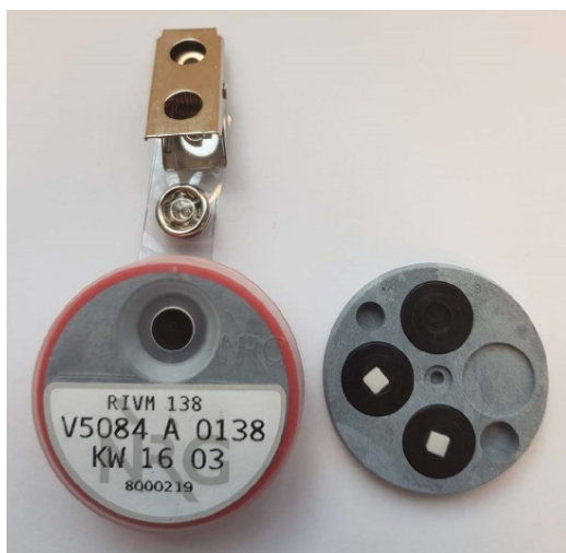
Figuur 2 Gedemonteerde gammadosimeter met rechts de binnenkant van de dosimeter met de twee voor de analyse gebruikte detectoren (Uit: de Jong, P. 2017)
