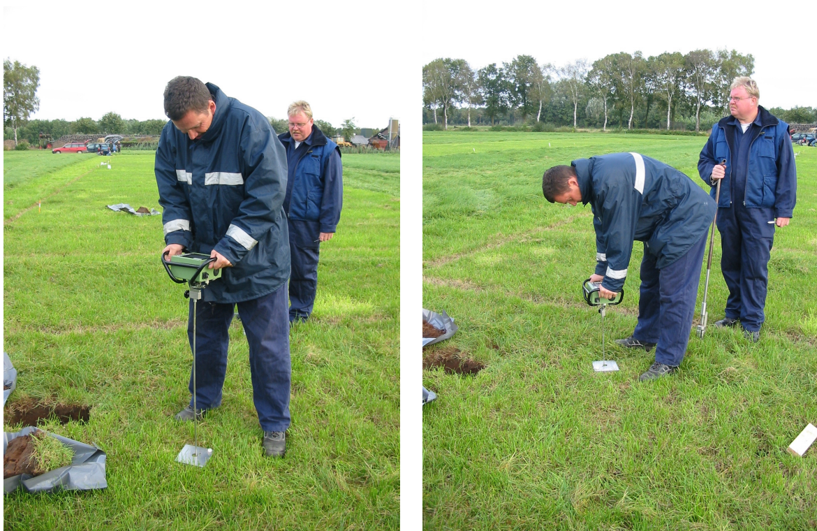
Figuur 8. Indringweerstand meten in het veld met een penetrologger. Aan de punt van de stang (circa 1 m lang) bevindt zich een conus (tophoek 60°) met een oppervlak van 1 cm 2 . De stang wordt met een snelheid van ongeveer 2 cm/sec de bodem in geduwd. Snelheid en diepte worden gemeten door een sensor, die een signaal stuurt naar het reflectieplaatje dat op de bodem ligt.
