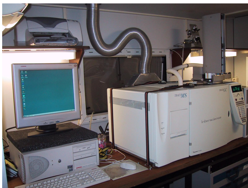
Foto 13: Trace GC-MS instrument van Interscience in mobiele laboratorium nr. 2 van het RIVM
