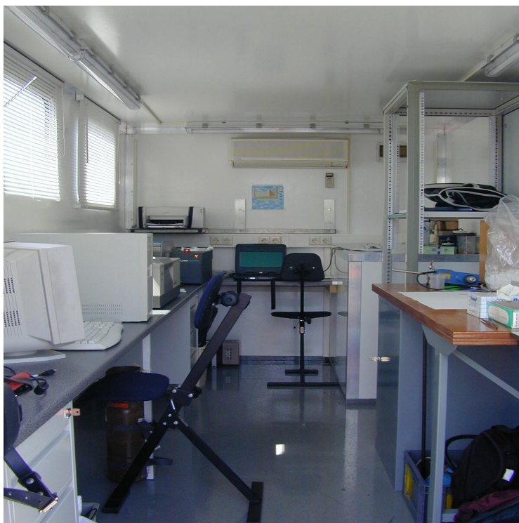
Foto 4: Interieur van het mobiele laboratorium met linksvoor het FTIR meetapparaat en linksachter het XRF Xepos meetinstrument
