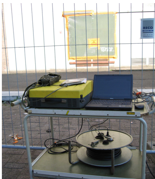
Figuur 7: Gasmet FTIR op 10-meterlijn (op locatie 1 van Figuur 9).
