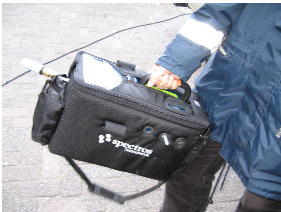
Figuur 1: Spectros voor het meten van lage concentraties sulfurylfluoride (0-100 ppm).
