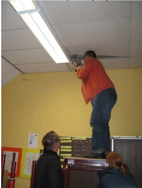
Figuur 3: Tedlarbag meting in plafond (klaslokaal).
