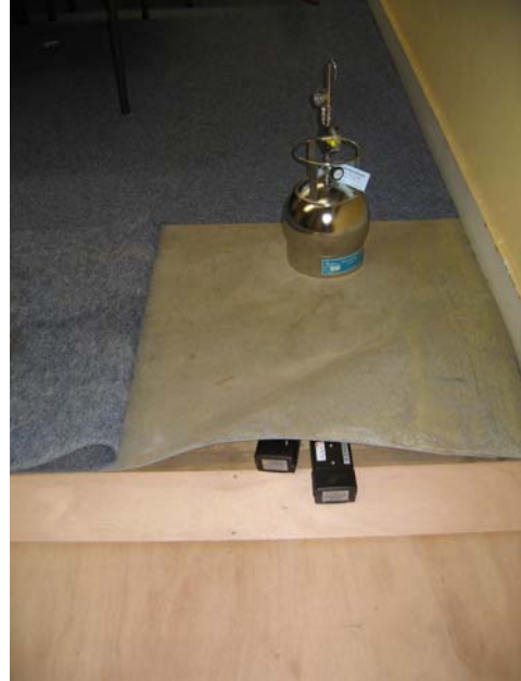
Figuur 2: Koolbuizen onder tapijt en Canister op tapijt
