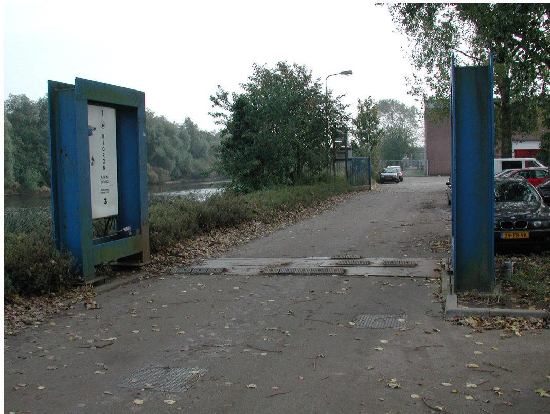
Figuur 1 Poortdetector van het type Bicron ASM 6000 III
