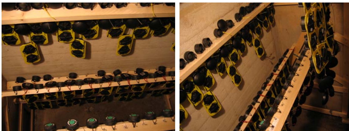
Figuur 6 Deelweergaven van de opstelling van detectoren nabij een betonnen muur; detectoren zijn geplaatst op de afstanden '0', 5, 10, 30 en 50 cm van de muur
