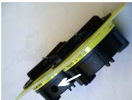
Figuur 7 Raduets in zijaanzicht; de pijl geeft één van de zes ingangen voor het meten van thoron
