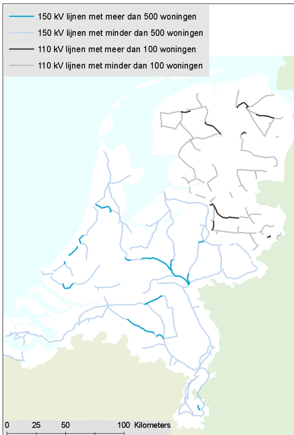
Figuur 7 Hoogspanningslijnen met meer dan 500 woningen binnen de indicatieve zone voor 150 kV en meer dan 100 woningen binnen de indicatieve zone voor 110 kV
