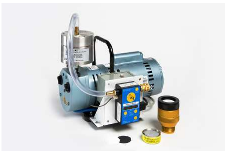
Foto 3 Bemonsteringapparatuur voor buitenlucht van de RIVM meetwagens. Rechts op de voorgond de aanzuigkop, die een glasvezel filter, een koolfilter en een koolpatroon bevat. Debiet : ca. 4,5 m 3 /h.
