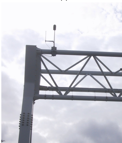
De microfoon(Larson-Davis 870) zoals die op het portaal gemonteerd is (a) en het portaal over de A12 bij Voorburg (b)
