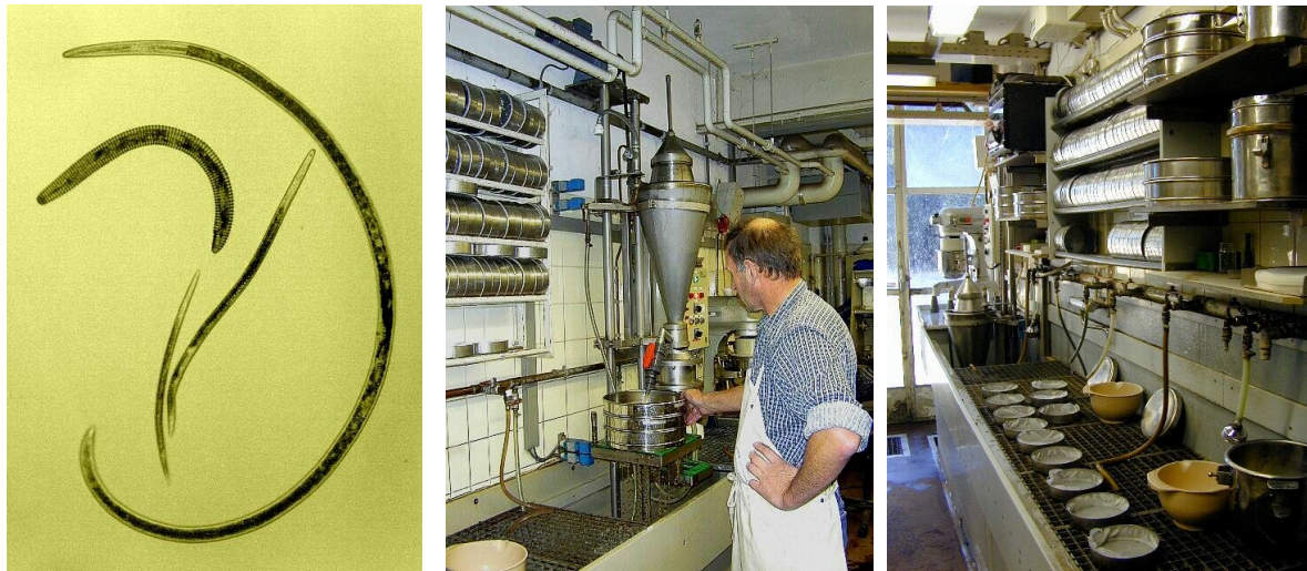
Figuur 7: Microscopische opname van bodemnematoden (links), Oostenbrink opspoeltrechter (midden) en zeefjes met wattenfilter voor laatste extractiestap (rechts)
