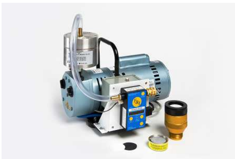
Foto 3 Bemonsteringapparatuur voor buitenlucht van de RIVM meetwagens. Rechts op de voorgrond de aanzuigkop, die een glasvezel filter, een koolfilter en een koolpatroon bevat. Debiet : ca. 4,5 m 3 /h.
