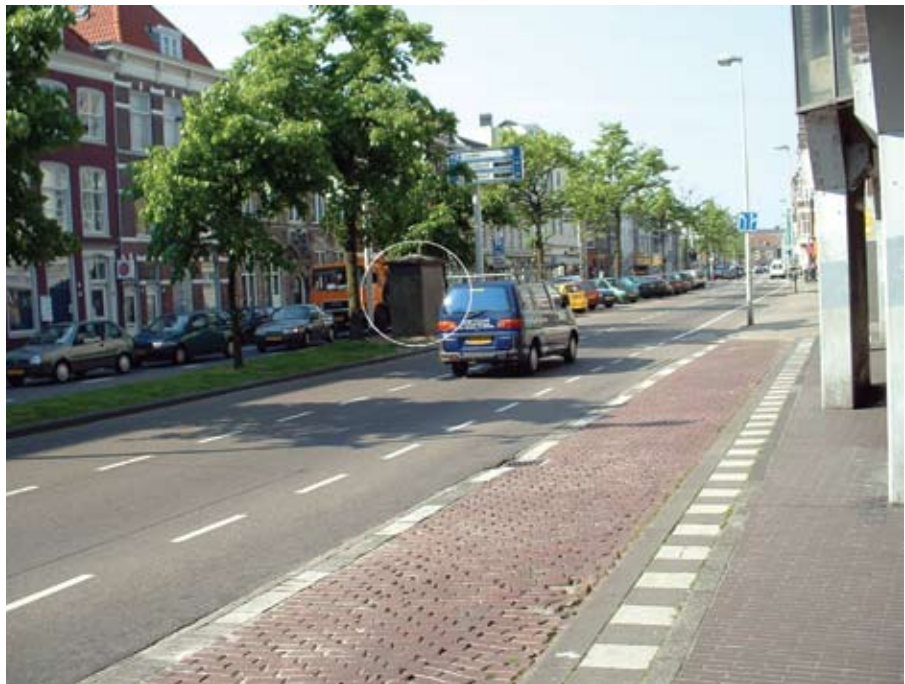
Figuur 1: Het meetstation van het Landelijk Meetnet Luchtkwaliteit aan de Amsterdamse Veerkade in Den Haag. Dit is een voorbeeld van een zogenaamd straatstation. Een straatstation geeft meetresultaten waarin de invloed van bronnen dichtbij, meestal het verkeer, duidelijk tot uiting komt. Dit soort stations dient onder andere om de luchtkwaliteit te meten daar waar de mensen zijn. (Bron: laboratorium voor milieumeting van het RIVM.)
