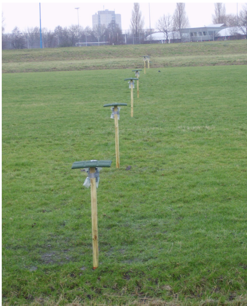
Figuur 5. De opstelling van de meetpalen in het veld tijdens de nulmeting; de foto is genomen kijkend naar het noorden; op de voorgrond staat meetpaal nr. 1 (zie Figuur 2)
