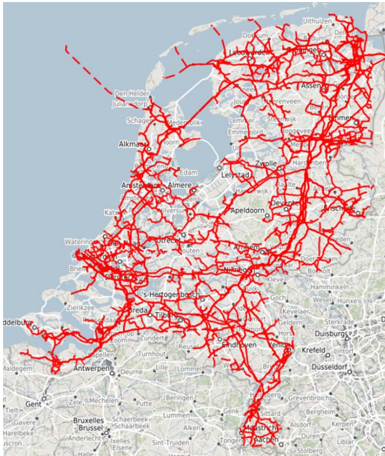
Figuur 2 Aardgasleidingen (> 50 mm en 16 bar), buisleidingen voor brandbare vloeistoffen (> 100 mm) en alle overige buisleidingen met overschrijding van de wettelijke norm voor plaatsgebonden risico op 5 m afstand [7]
