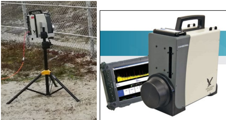
Figuur 4 Falcon 5000 draagbare gammaspectrometrie opstelling
