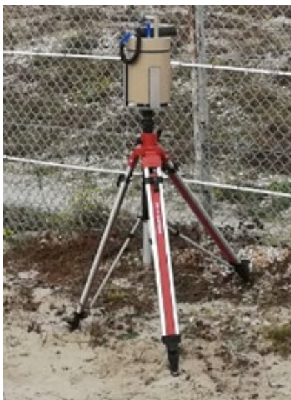
Figuur 5 Biorem FHT752 neutronenmonitor met ^{10}\text{BF}_3 detector.
