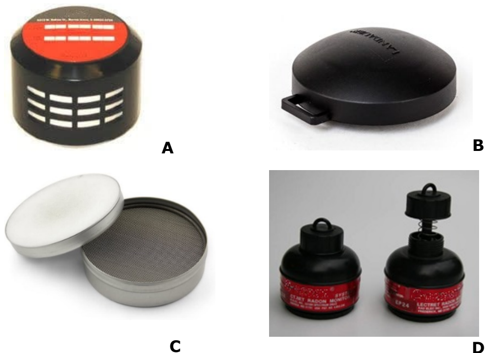
Figuur 3 Voorbeelden van radonmeters: A open alfa-track detector, B gesloten alfa-track detector, C activated charcoal detector, D electret.
