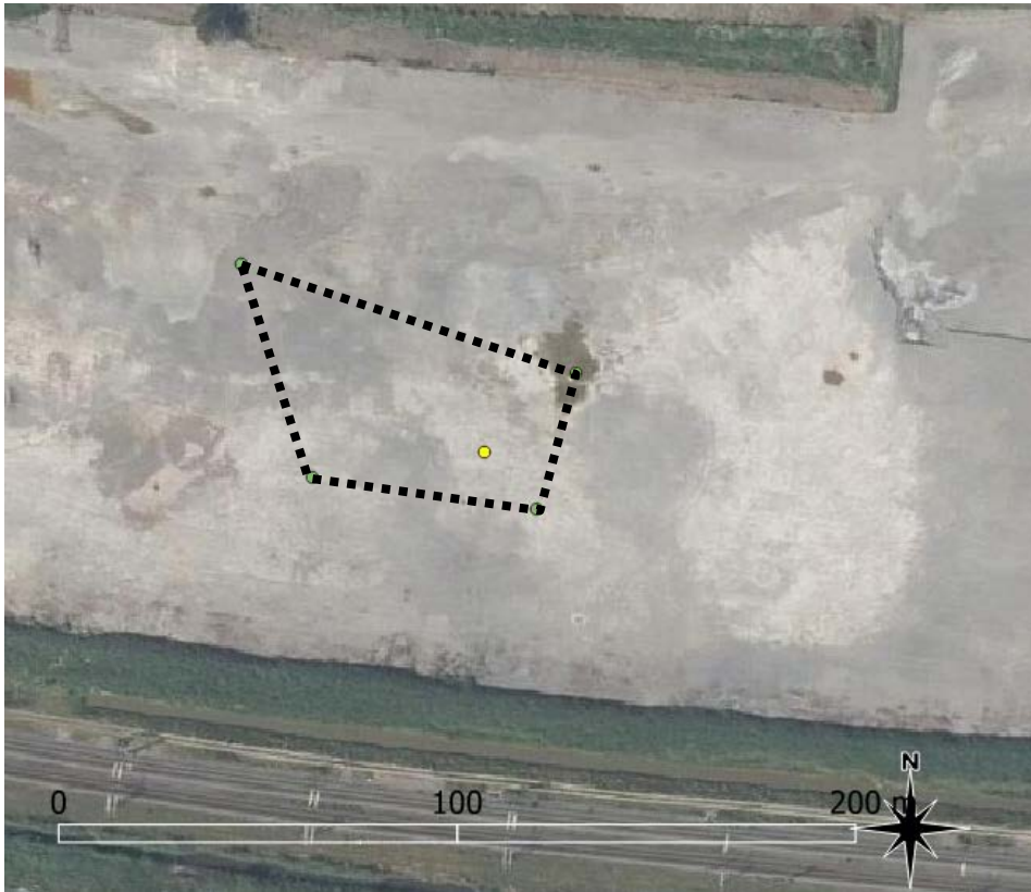
Figuur 3 Luchtfoto van veld 2. De gele stip geeft de locatie waar het gammaspectrum is opgenomen. De zwarte stippellijn geeft de randen van de heuvel staalslakken (hoogte van circa 1,65 m) ten tijde van de meting.
