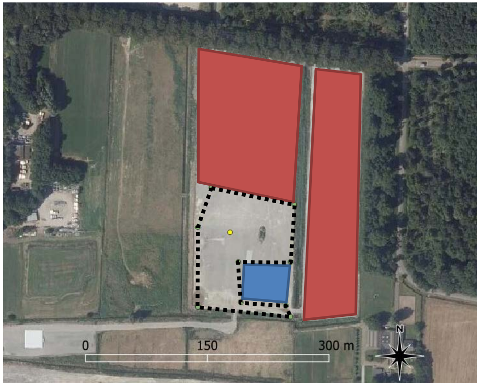
Figuur 2 Luchtfoto van veld 1. De gele stip geeft de locatie waar het gammaspectrum is opgenomen. De zwarte stippellijn geeft de randen van het veld ten tijde van de meting. De rode vlakken zijn gebieden waar de staalslakken waren afgegraven. Het blauwe vlak is een bassin met water.
