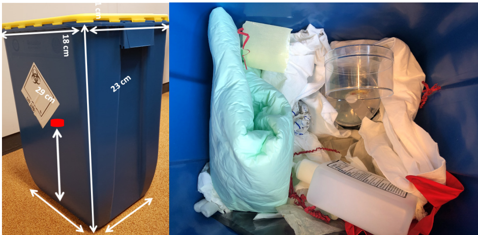
Figuur 3 Foto's van het afvalvat met niet-radioactief afval. De puntbron met Eu-152 zit op de plek van de rode stip (links).
