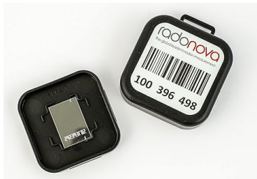
Figuur 3.1 Opengemaakte Radtrak 3 radonmeter. Figuur uit [19].
