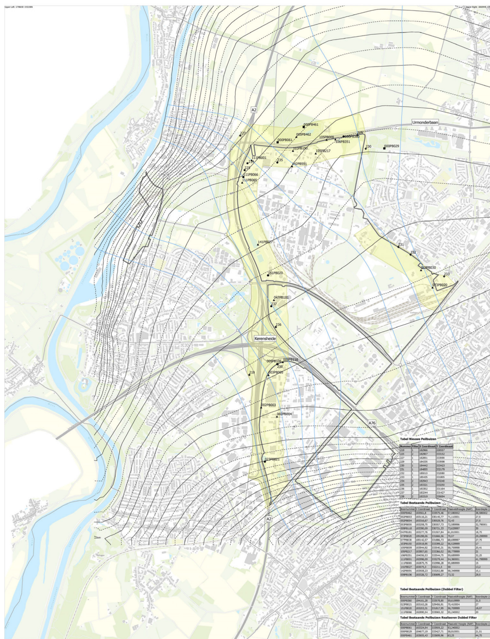
Figuur 6.2 Kaart van de signaleringszone Chemelot (lichtgele contour), gecombineerd met grondwater isohypsen (zwarte dunne lijnen) en stroombanen (lichtblauwe lijnen) zoals vastgesteld in 2021. In de figuur zijn rechtsonder bestaande en nieuw te plaatsen peilbuizen in een tabel aangegeven. Voor de bestaande peilbuizen zijn de boordiepten aangegeven. (Figuur 23 Arcadis, 2021d).
