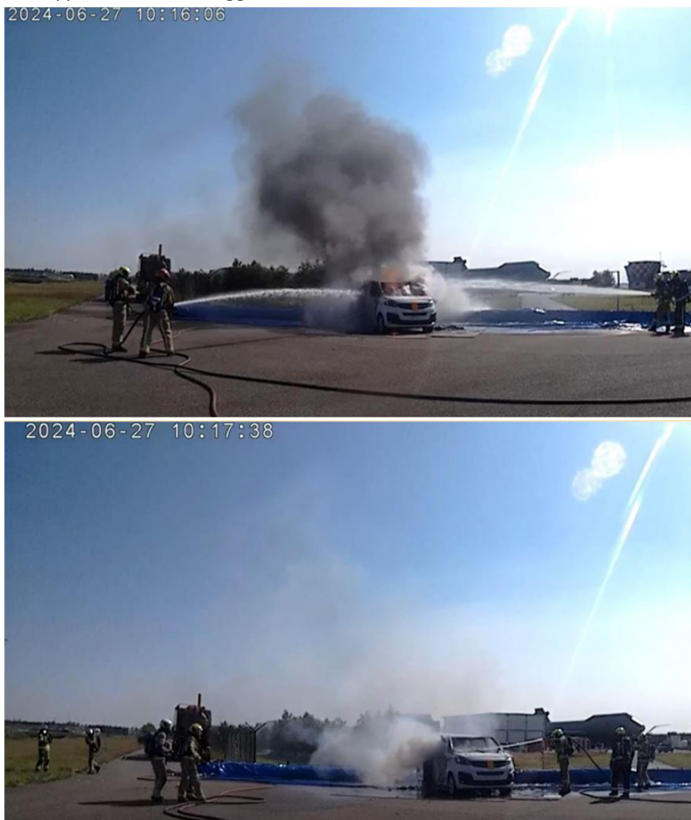
Figuur 19 Inzet van de blussing bij experiment 1 (Foto's: Hessels en Brans 2024). Na deze blussing is de meetapparatuur verplaatst. Op tijdstip 10:17 uur wordt de auto vanaf de bestuurder zijde geblust, waardoor de rook van de meetapparatuur wordt weggeduwd.
