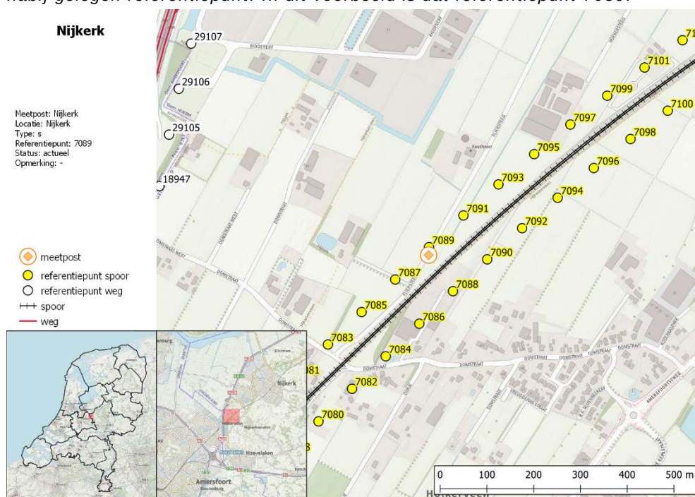
Figuur 1 Voorbeeld van een meetlocatie langs een hoofdspoorweg (oranje). ProRail rapporteert jaarlijks over de naleving van vastgestelde geluidproductieplafonds op alle referentiepunten. Met metingen worden deze waarden steekproefsgewijs gevalideerd door terug te rekenen naar het meest nabij gelegen referentiepunt. In dit voorbeeld is dat referentiepunt 7089.
