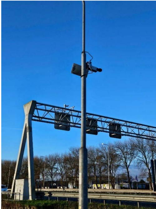
Figuur 2 Voorbeeld van een meetlocatie met MK3-geluidmeter en bijbehorend zonnepaneel. De microfoon hangt op 4 meter hoogte in een lichtmast.
