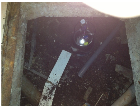
Figuur 4.4 Barneveld. Bemonstering bodemlucht met canister in kruipruimte.
