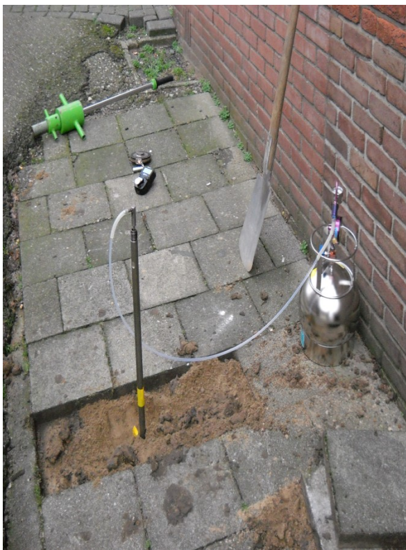
Bemonstering bodemlucht met canister Figuur 4.3 Elst
