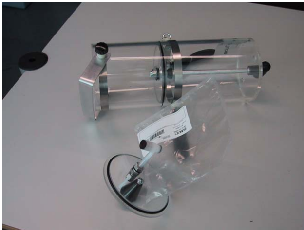
Figuur 2 Een Vac-U-tube met een tedlarbag
