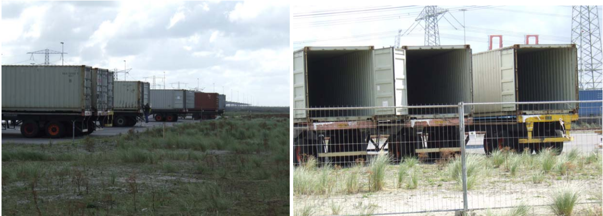
Figuur 6 Opstelling van containers in het experiment waarbij op de linkerfoto de drie groepen van drie containers te zien zijn en op de rechterfoto één groep van drie geopende containers
