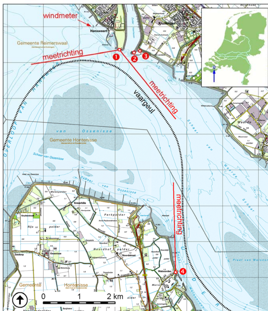
Figuur 2-4. Meetlocaties Hansweert, gemarkeerd met 1, 2 en 3, en Walsoorden, gemarkeerd met 4. Voor locatie 1 en 4 zijn de meetrictingen weergegeven. Windmeter: meetpaal van Rijkswaterstaat waar windsnelheid, windrichting en waterhoogte gemeten worden.
