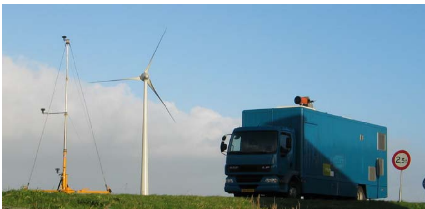
Figuur 2-7. De meetwagen op de dijk bij het Houtrakgemaal (locatie 6). De windmast staat links van de windmolen.
