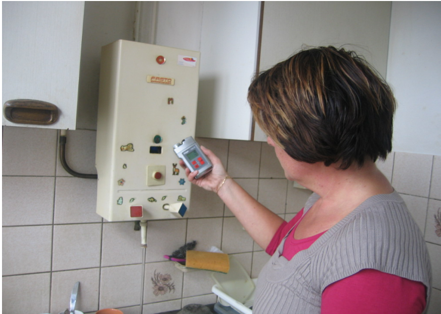
Foto 1: Koolmonoxidemeting bij een afvoerloze geiser in Schiedam.
