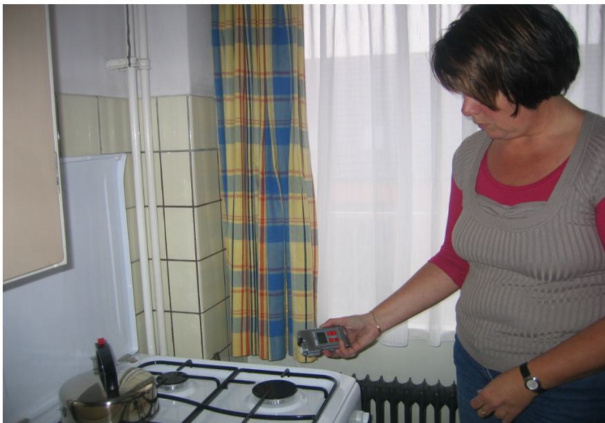
Foto 2: Koolmonoxidemeting bij een gasfornuis in Schiedam.
