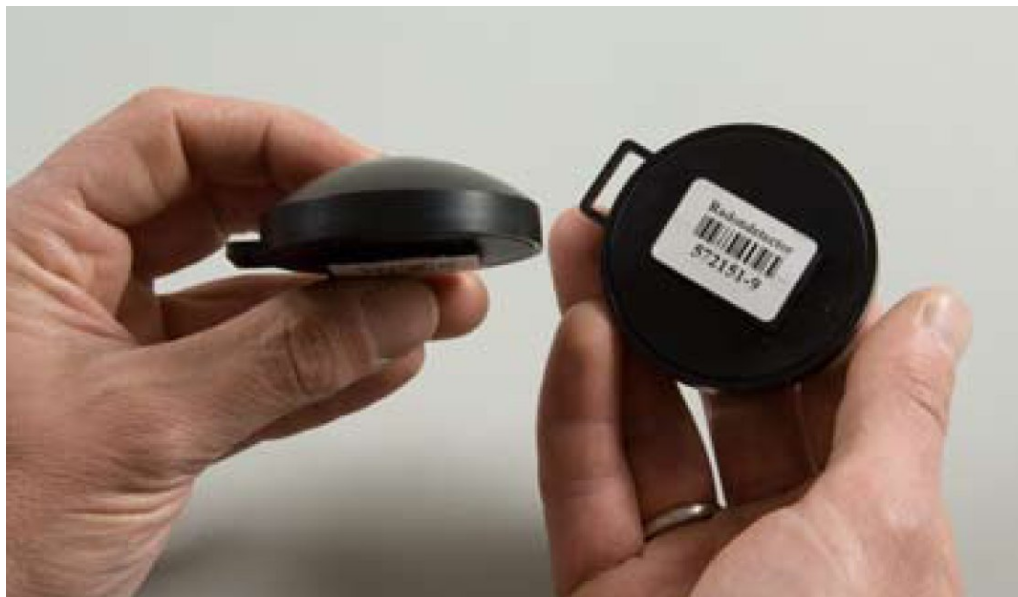
Figuur 5 Onder- en zijaanzicht van de in de survey toegepaste radondetector (Gammadata)
