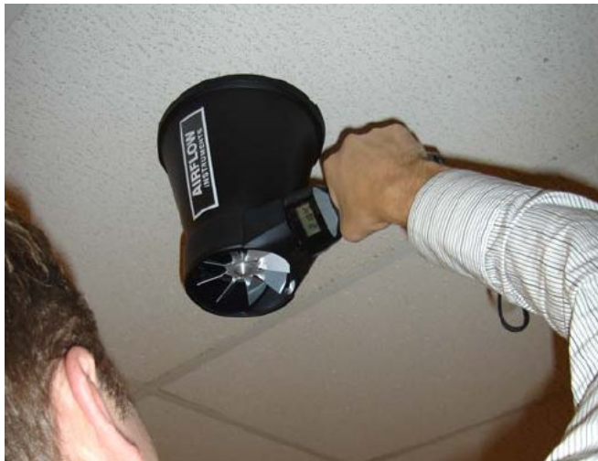
Figuur 9 Observer schoepenradanemometer voor het meten van de ventilatiecapaciteit van een mechanisch ventilatie systeem
