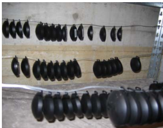
Figuur 11 Meting effect thoron ( ^{220}\text{Rn} ) met radon-detectors op verschillende afstanden van muur.
