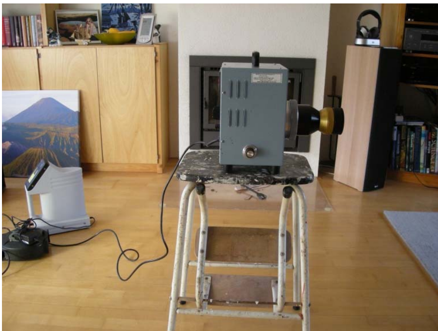
Figuur 3 Opstelling van aanzuigsysteem met filter voor meting thoronvervalproducten
