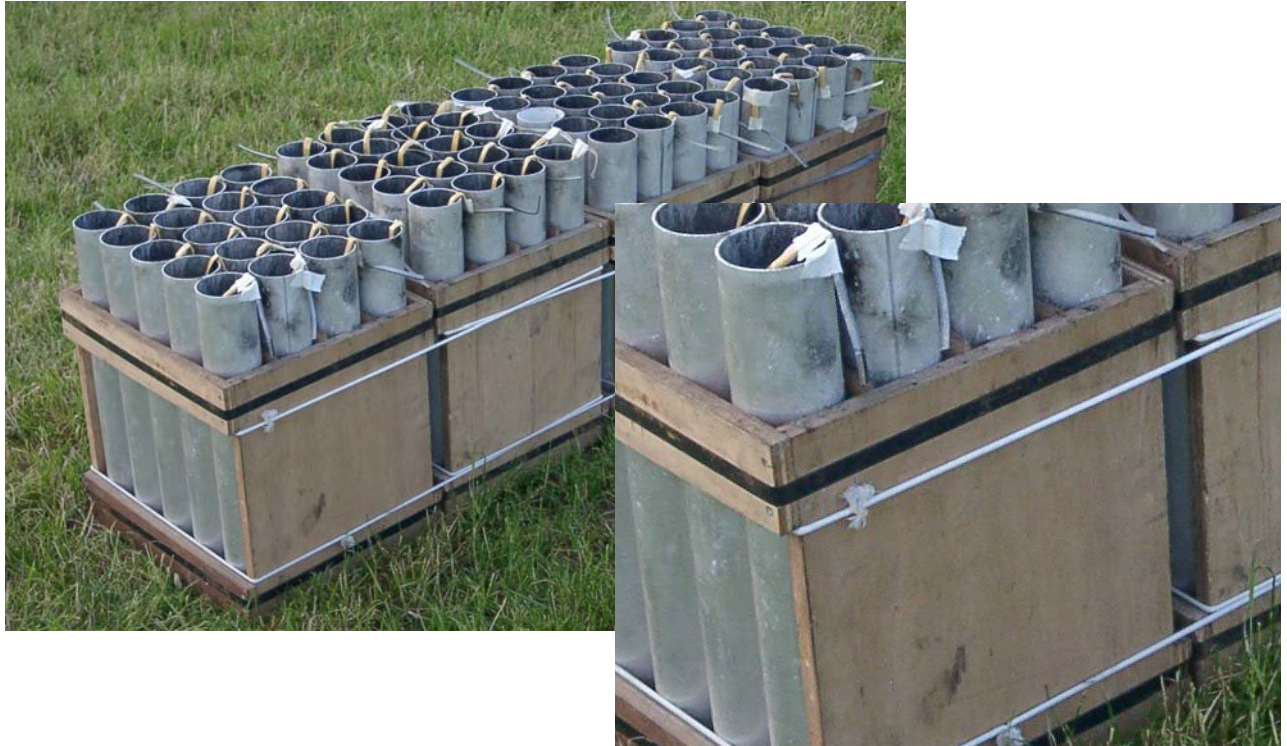
Figuur 5: Mortierrekken die bij elkaar gehouden worden door zeilelastieken die bij een ongewoon voorval waarschijnlijk onvoldoende sterk zijn om de rekken bij elkaar te houden.
