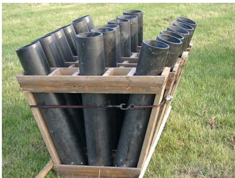
Figuur 4: Voorbeeld van een samengesteld mortierrek dat gevoelig is voor kantelen bij afvuren.
