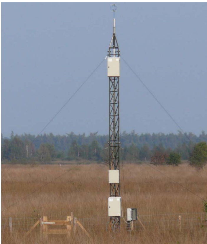
Figuur 3 De meetmast van de COTAG-depositiemeetopstelling
