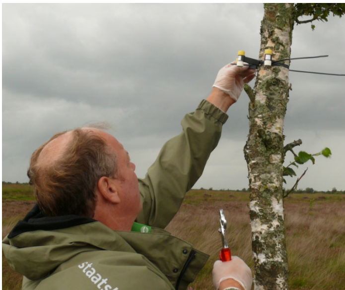
Figuur 2 Plaatsing van de passieve samplers op meetpunt 2-2
