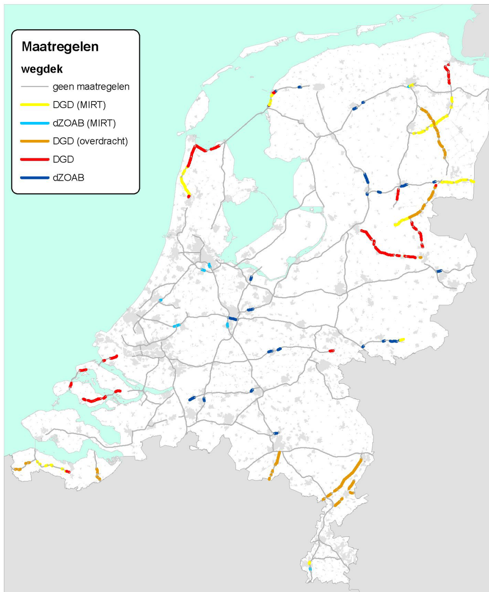
Figuur 3: Overzicht van de maatregelen aan het wegdek. Bij A-wegen met v < 100 km/u en N-wegen wordt DGD toegepast, elders 2-laags ZOAB. Verder zijn MIRT-projecten en over te dragen wegen apart weergegeven.
