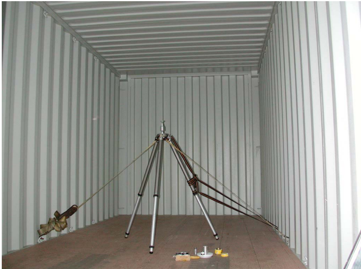
Figuur 2: Achteraanzicht van de (geopende) container. In het midden is een statief geplaatst en met sjorbanden aan de container bevestigd. Op dit statief konden de verschillende testbronnen worden geplaatst (enkele daarvan zijn zichtbaar op de voorgrond).
