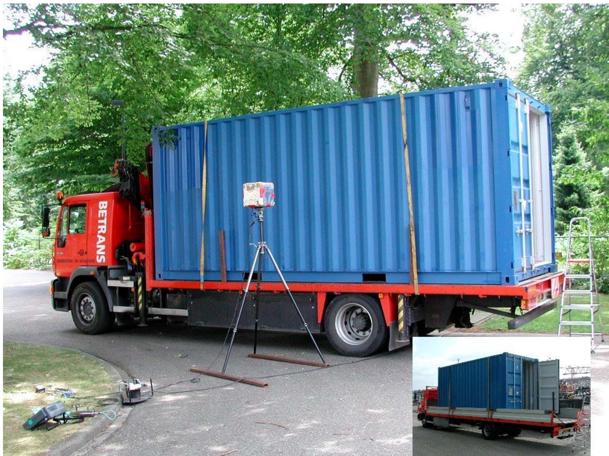
Figuur 1: Een van de twee vrachtwagens (zie inzet voor de andere) gebruikt voor het ringonderzoek. De toegepaste container was steeds dezelfde. Naast de container is op een statief de Reuter Stokes ionisatiekamer zichtbaar. Hiermee werd het dosistempo van de in de container geplaatste bronnen gemeten op een afstand van 230 cm.
