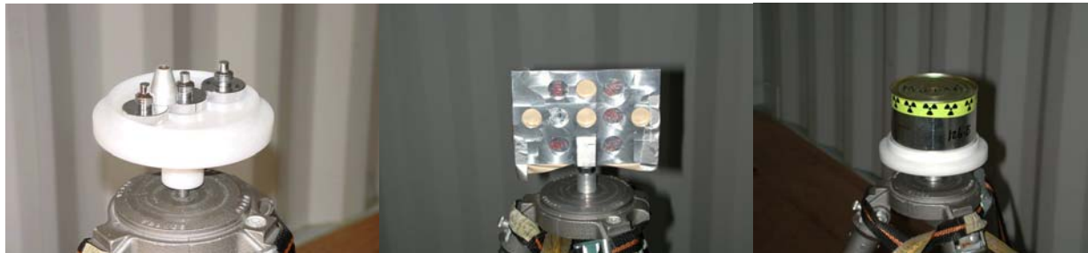
Figuur 3: Enkele van de toegepaste bronnen geplaatst op het statief: de grootste ^{137}\text{Cs} bron (links) bestaande uit 4 kleinere bronnen, de middelgrote ^{60}\text{Co} bron (midden) bestaande uit 6 deelbronnen in een metaalfolie en de middelgrote ertsbron (rechts) bestaande uit een ingeblikte hoeveelheid tantaliet erts. Zie voor alle gebruikte bronnen Tabel 1.
