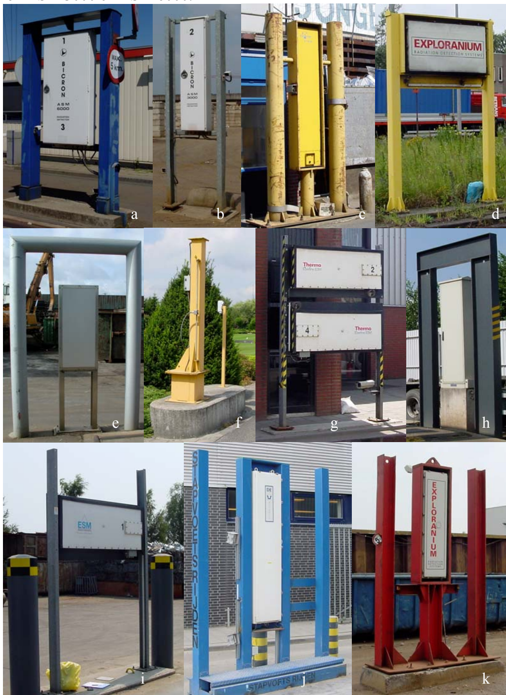
Figuur 4: De elf verschillende detectorsystemen zoals aangetroffen in het ringonderzoek: a) Bicron ASM 6000, b) Bicron ASM 3000, c) RAD/COMM RC400, d) Exploranium GR-526, e) RAMBO PVT5000, f) Ronan Interceptor 200, g) Eberline FHT1388, h) RADOS RTM910, i) Eberline FHT8000, j) Dansteel GRD23000, k) Exploranium GR510/2200.
