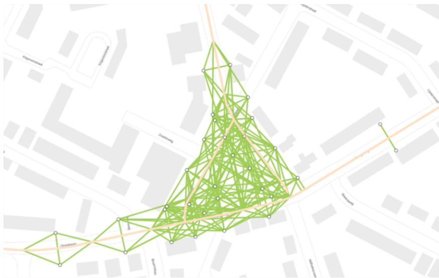
Figuur 1 Voorbeeld van een kruispunt waar receptoren (witte punten) aan een groot aantal SRM1-wegsegmenten (geel) zijn gekoppeld. De groene lijnen geven de overdrachtslijnen weer.
