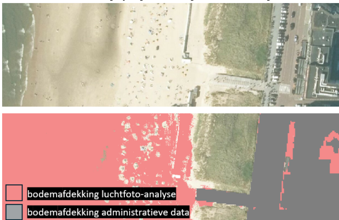
Figuur 7: bodemafdekking op het strand bij Egmond aan Zee. Hier overschat de luchtfoto-methode: het strand en intergetijdengebied wordt geclassificeerd als afgedekte bodem.
