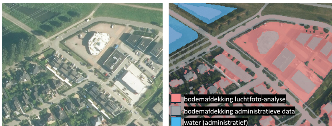
Figuur 6: bodemafdekking in woonwijk Tussen de Vaarten in Almere met naastgelegen bedrijfsterrein en gebedshuis. Te zien is dat op basis van de administratieve data de afgedekte bodems rondom de gebouwen niet worden gezien als afgedekt, terwijl de luchtfoto-analyse dat wel doet.
