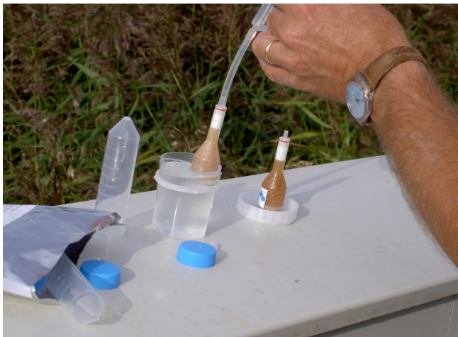
Figuur 1 Het voorbereiden (doorspoelen met schoon water) van een SorbiCell
