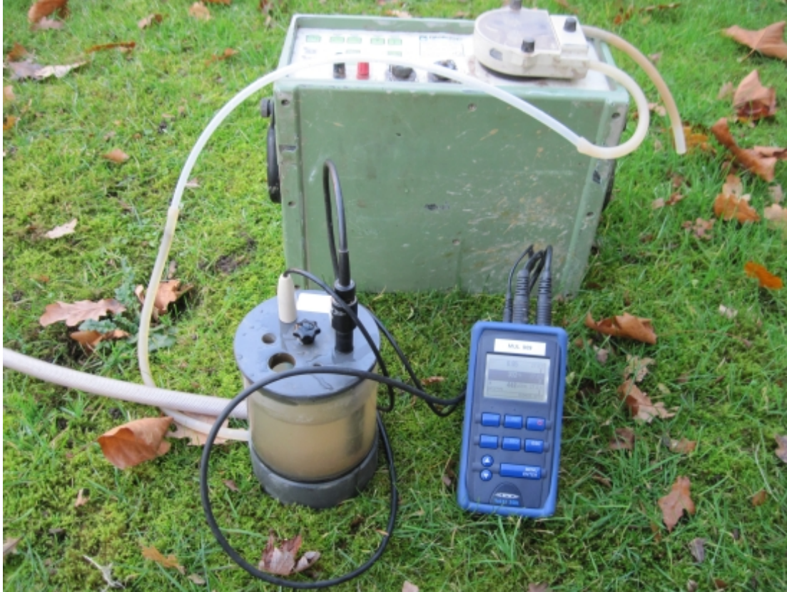
Figuur 1: De doorstroomcel met elektrodes (links) en de multimeter (rechts). Bovenaan staat de slangpomp die het grondwater uit het boorgat en door de doorstroomcel pompt
