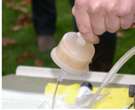
Figuur: Membraanfilter wordt in de filterhouder gelegd (foto links) en in-line filter in gebruik bij het vullen van een monsterflesje (foto rechts)
