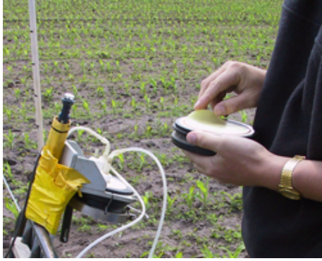
Figuur: Membraanfilter wordt in de filterhouder gelegd (foto links) en in-line filter in gebruik bij het vullen van een monsterflesje (foto rechts)
