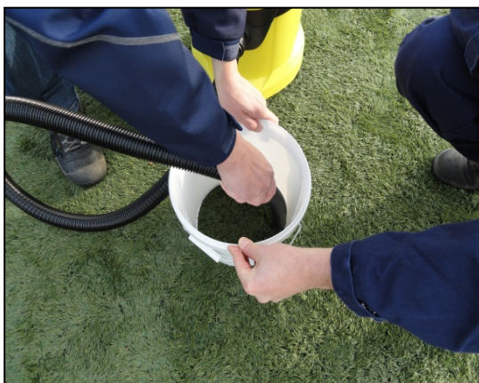
Figuur 4: Bemonstering van rubbergranulaat met een stofzuiger (links) en vulling van een glazen pot met het bemonsterde materiaal (rechts)
