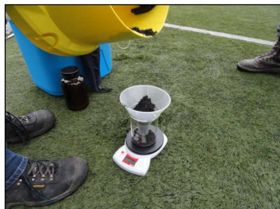
Figuur 4: Bemonstering van rubbergranulaat met een stofzuiger (links) en vulling van een glazen pot met het bemonsterde materiaal (rechts)
