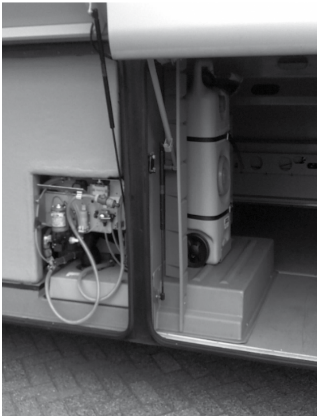
Figuur 2 De waterinstallatie van de bus met een schoonwatertank en een afvalwatertank
