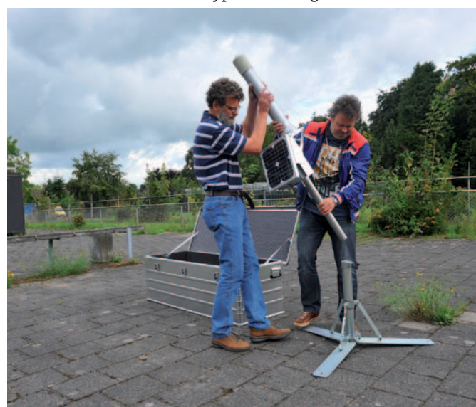
Met mobiele monitoren kan bij incidenten de verspreiding van radioactiviteit nauwkeuriger in beeld worden gebracht.
