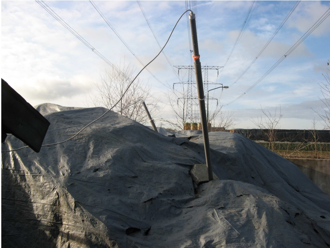
Foto 1: Meetlans zoals gebruikt voor het meten van de temperatuur in de mesthoop (foto Daan Dercksen, Gezondheidsdienst voor Dieren)
