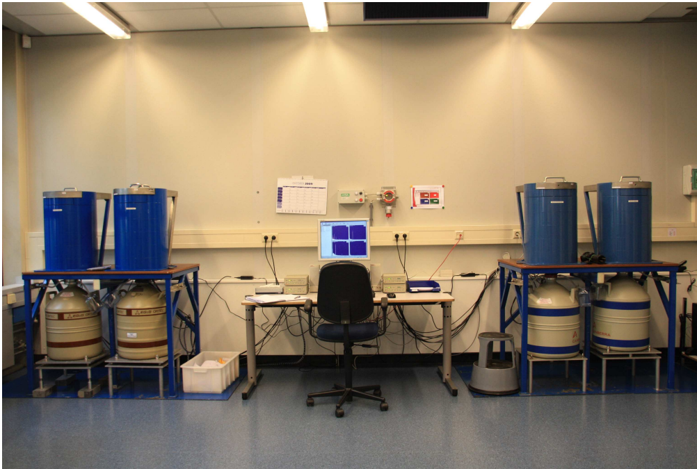
Foto 8 Meetopstellingen voor gammaspectrometrie, in het radionuclidenlaboratorium van het RIVM
