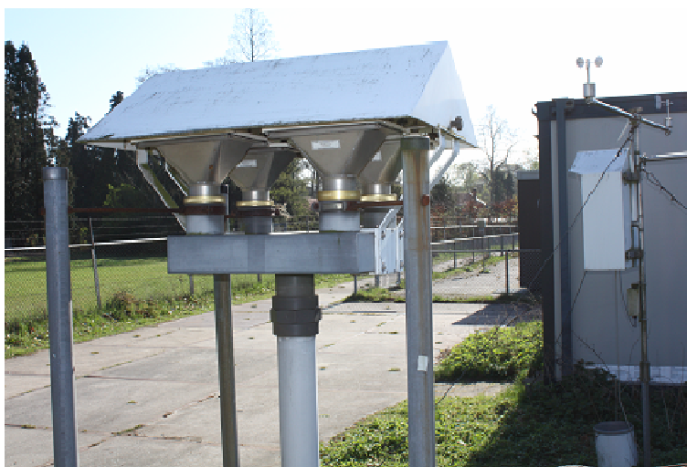
Foto 2 Bemonstering van luchtstof met de High Volume Sampler (HVS), op een monsternameplein aan de rand van het RIVM terrein. Debiet: 300 m 3 /h.
