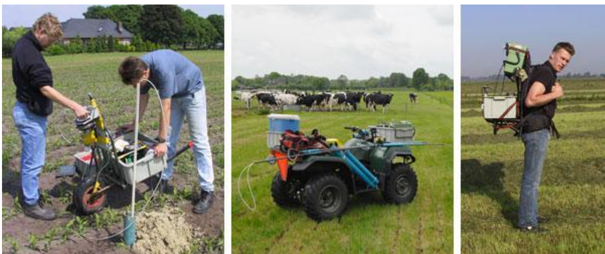
Figuur 2 Vervoer van apparatuur en hulpmiddelen met een steenkruiwagen (links), met een quad (midden) en met de rugzak (rechts)
