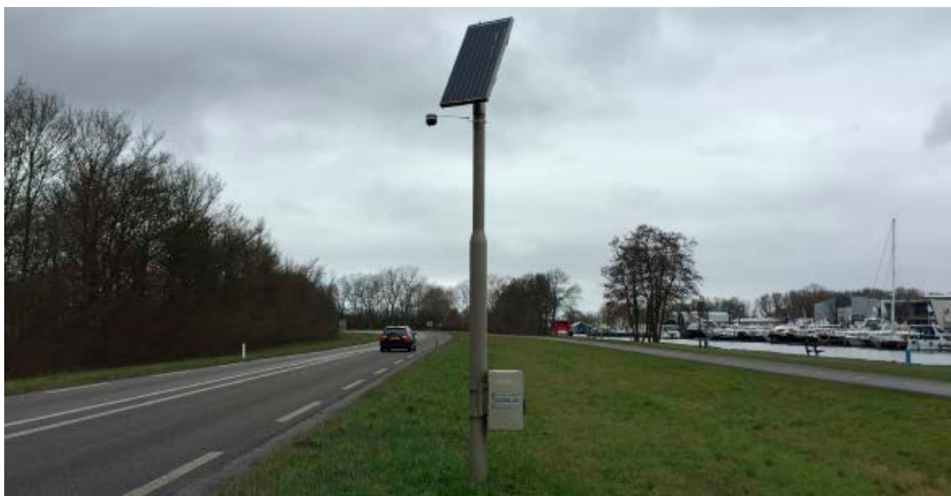
FIGUUR 1: DE MEETOPSTELLING LANGS DE N309 BIJ ELBURG BESTAAT UIT EEN GELUIDMETER MET WINDBOL, ZONNEPANEEL EN TELLUS-REGISTRATIE.
