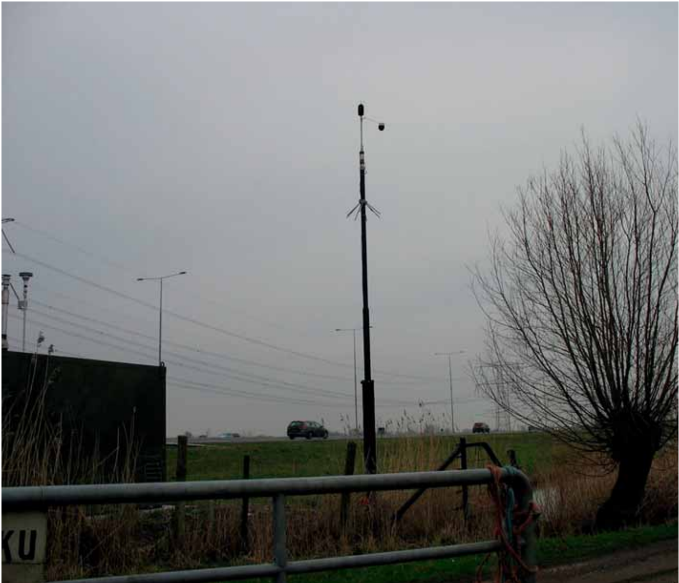
FIGUUR 4: GELUIDMEETPOST RIVM LANGE DE A2 BIJ BREUKELLEN (FOTO:RIVM)
