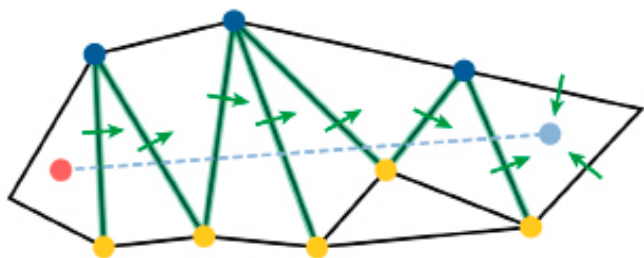
FIGUUR 3: VISUALISATIE VAN HET "LOPEN" OVER EEN TIN; DOOR MIDDEL VAN EEN WISKUNDIGE TEST KAN WORDEN BEPAALD WELKE ZIJDE DE DOORSNEDE SNIJDT EN IN WELKE RICHTING 'GELOPEN' MOET WORDEN (AANGEGEVEN MET DE PIJLTJES, DIE BIJ HET EINDPUNT ALLE NAAR BINNEN WIJZEN EN DAARMEE AANGEVEN DAT HET EINDPUNT BEREIKT IS).
